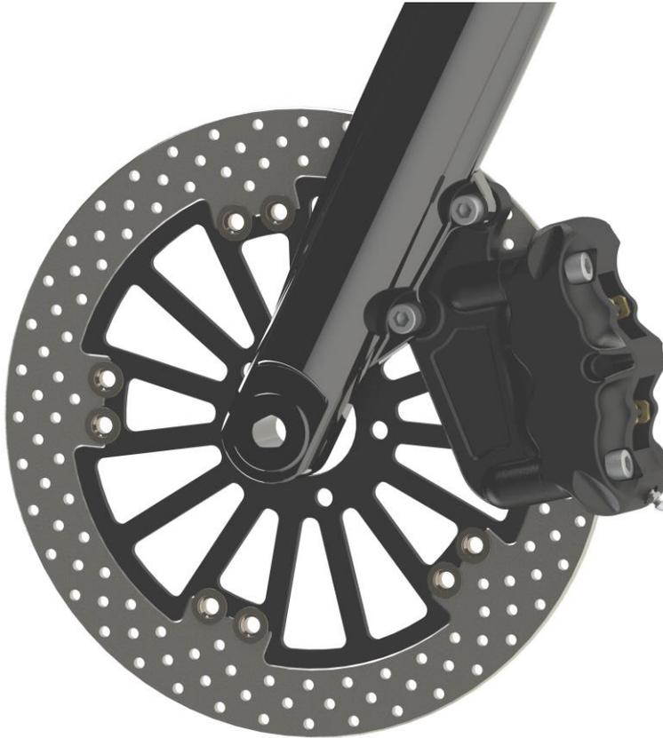
Entlüften Sie das Bremssystem und überprüfen Sie die korrekte Funktion der vorderen Bremsanlage!
