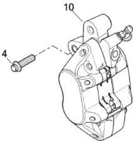
Montieren Sie den neuen TB-Bremszangenadapter mit den beiliegenden Befestigungsschrauben an der Gabel und ziehen Sie die Schrauben mit 35 Nm (25 ft-lbs) fest.
