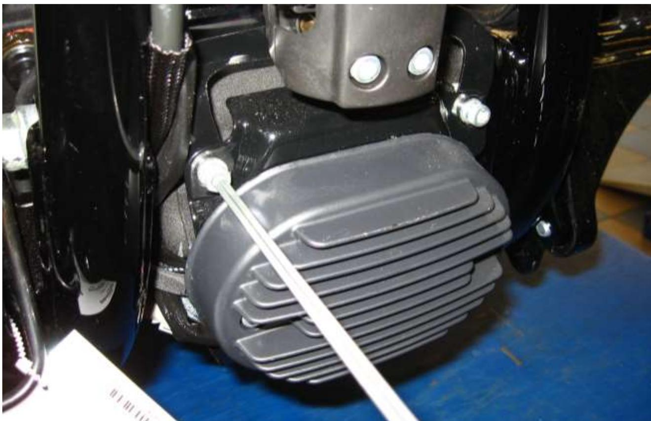
Demontieren Sie die rechte Fußrasteneinheit.
