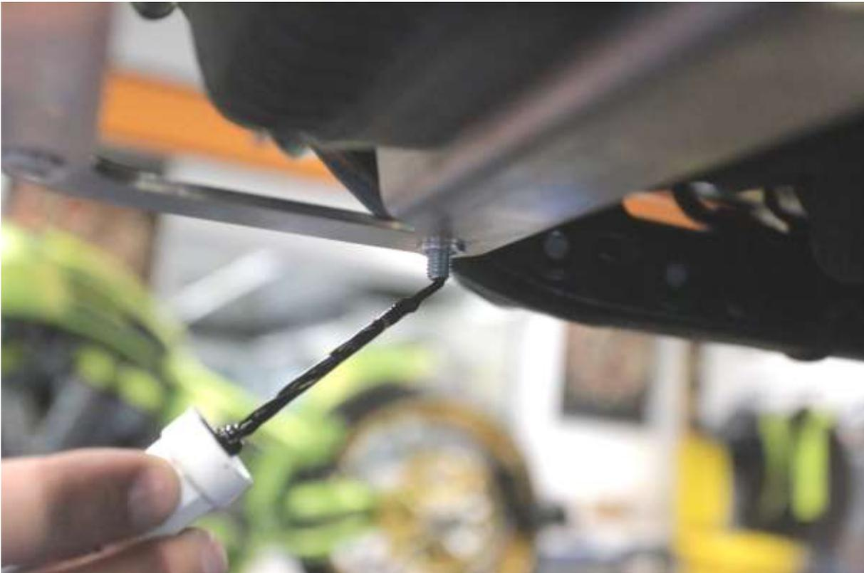
Drücken Sie den Bugspoiler nun von unten gegen den Halter, sodass sich die Markierungspunkte der Schrauben im Bugspoiler abzeichnen.
