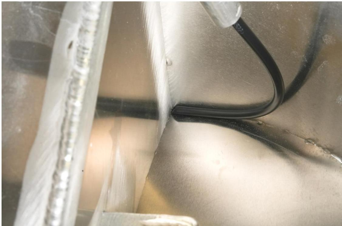
Bild zeigt schräg abgeschnittenen Schlauch im Tankinneren
