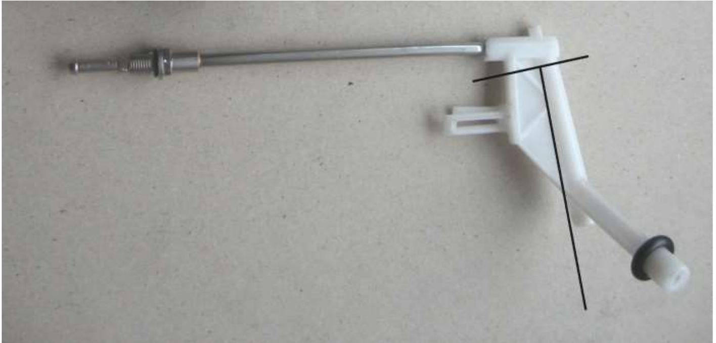
Kürzen Sie das Entlüfterrohr um 55mm und stecken Sie den Aufsatz wieder auf.
