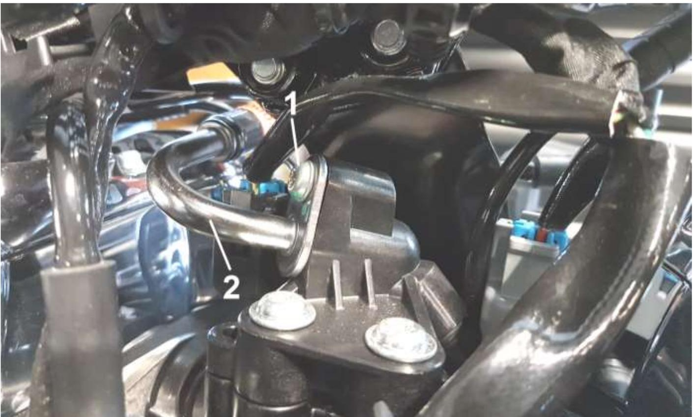
Feilen Sie die Blechummantelung am Leitungsanschluss auf und schieben Sie die Leitung herunter. Wiederholen Sie das am zweiten Anschluss.
