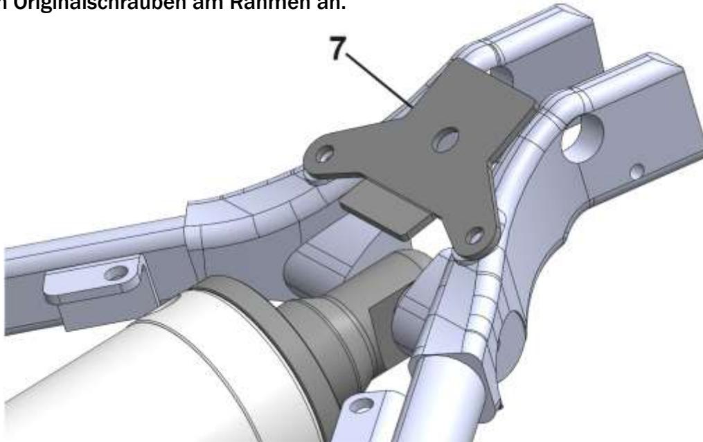
Montieren Sie den neuen Tank mit dem beiliegenden Tankhalter und den Kunststoffscheiben an der vorderen Halterung.
