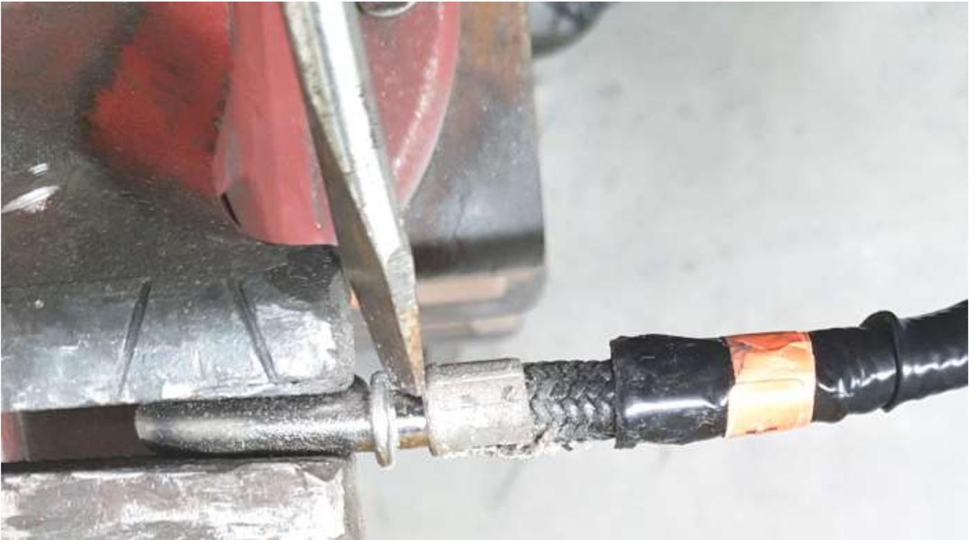
Stecken Sie die neue Leitung auf die Anschlüsse und sichern sie mit den Schellen.
