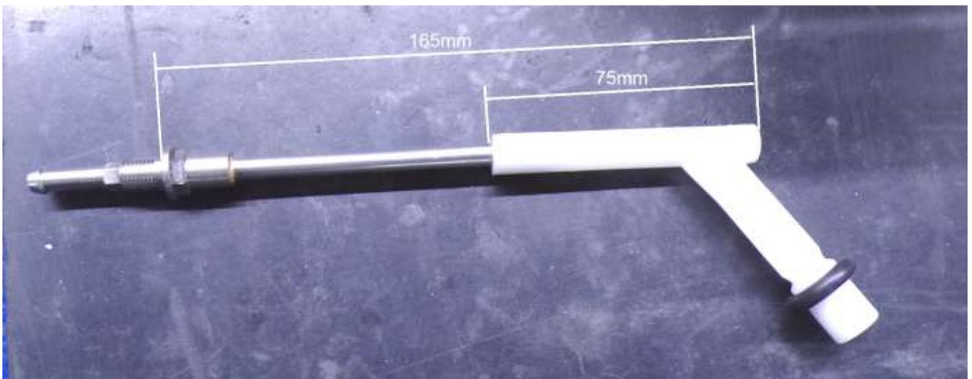
Montieren Sie das gekürzte Entlüfterrohr wieder an der Pumpengrundplatte.
