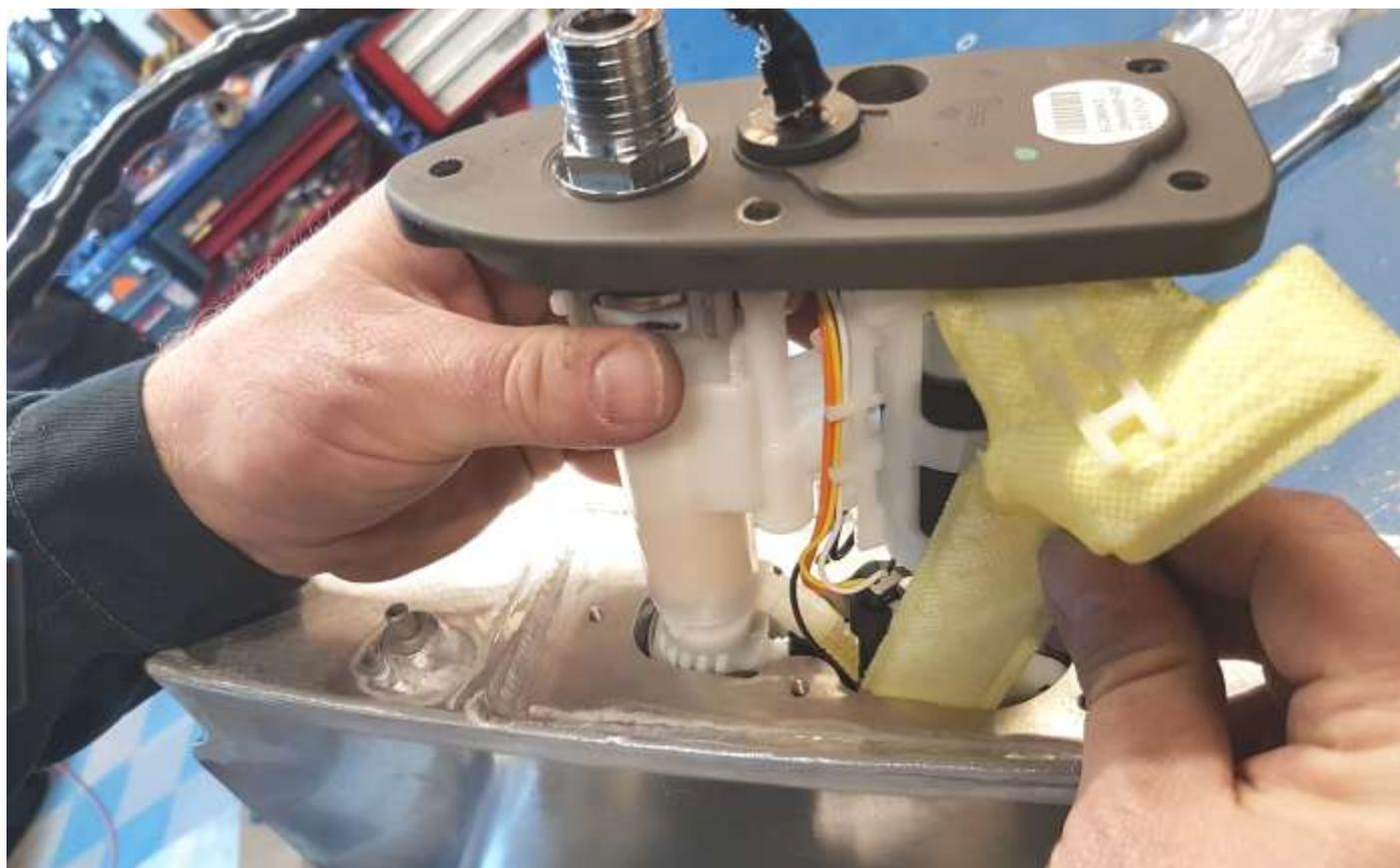
Schrauben Sie das Entlüfterrohr von der Pumpengrundplatte ab.
