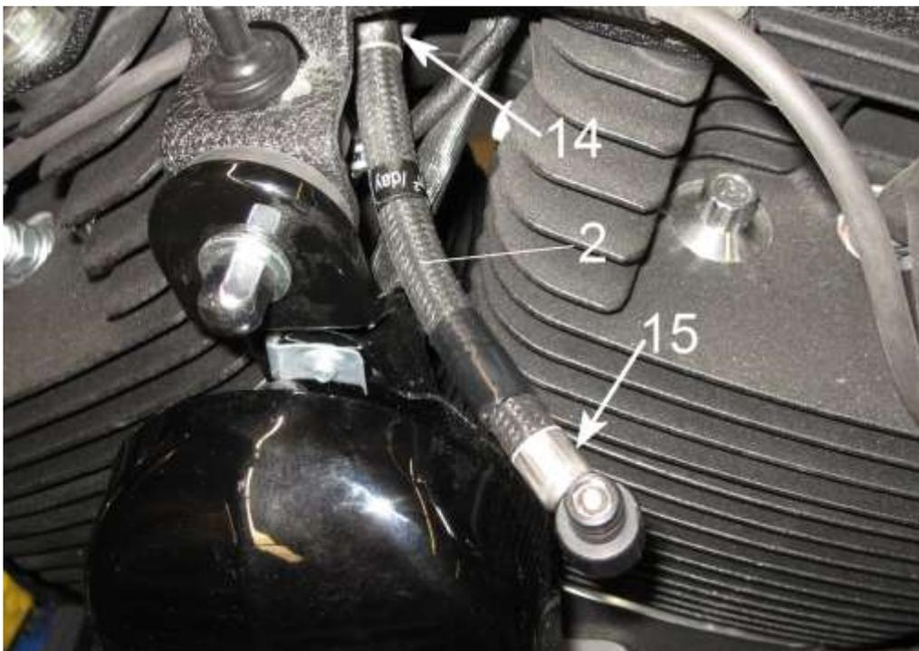
Trennen Sie die Verpressungen (14 + 15) der Benzinleitung vorsichtig auf ohne die unter dem Schlauch liegenden Tüllen zu beschädigen!
