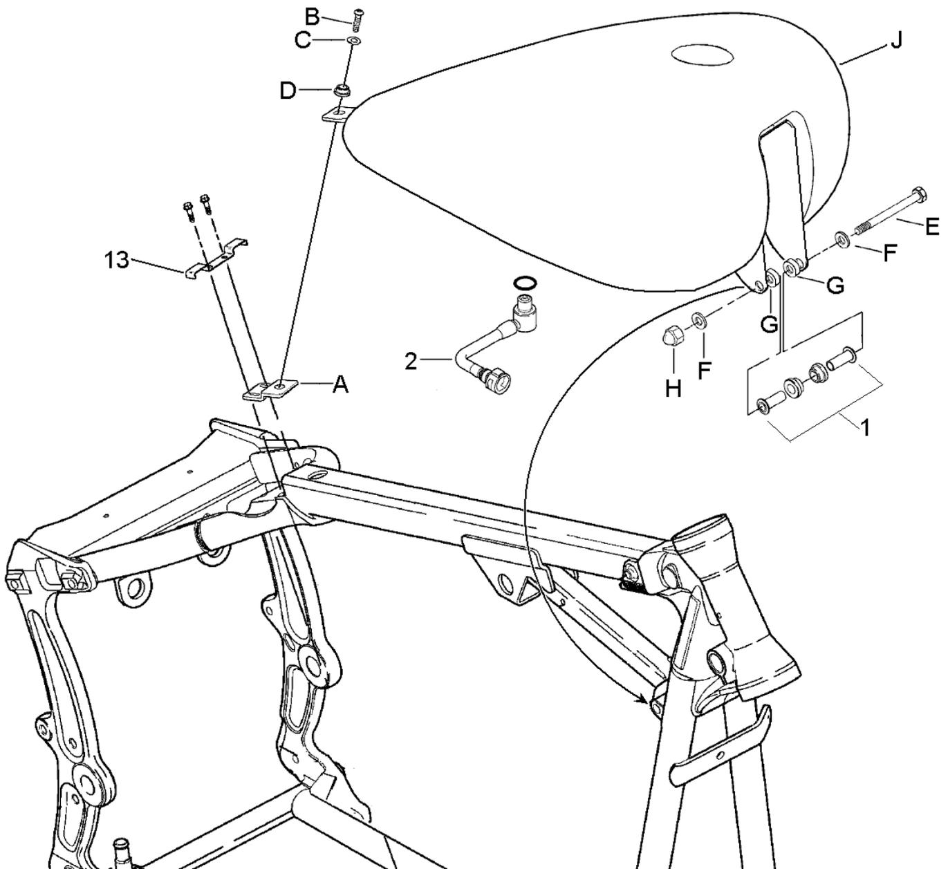
Schrauben Sie die neue hintere Tankhalterung (A) zusammen mit der Kabelbaumhalterung (13) am Rahmen an.
