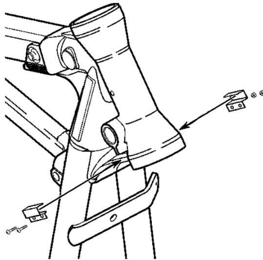
Bei anderen Modellen kann es bei Verwendung anderer Gabelbrücken, Risern oder Lenkern ebenfalls notwendig sein den Lenkschlag zu begrenzen. Prüfen Sie das vor der endgültigen Montage des Tanks!
