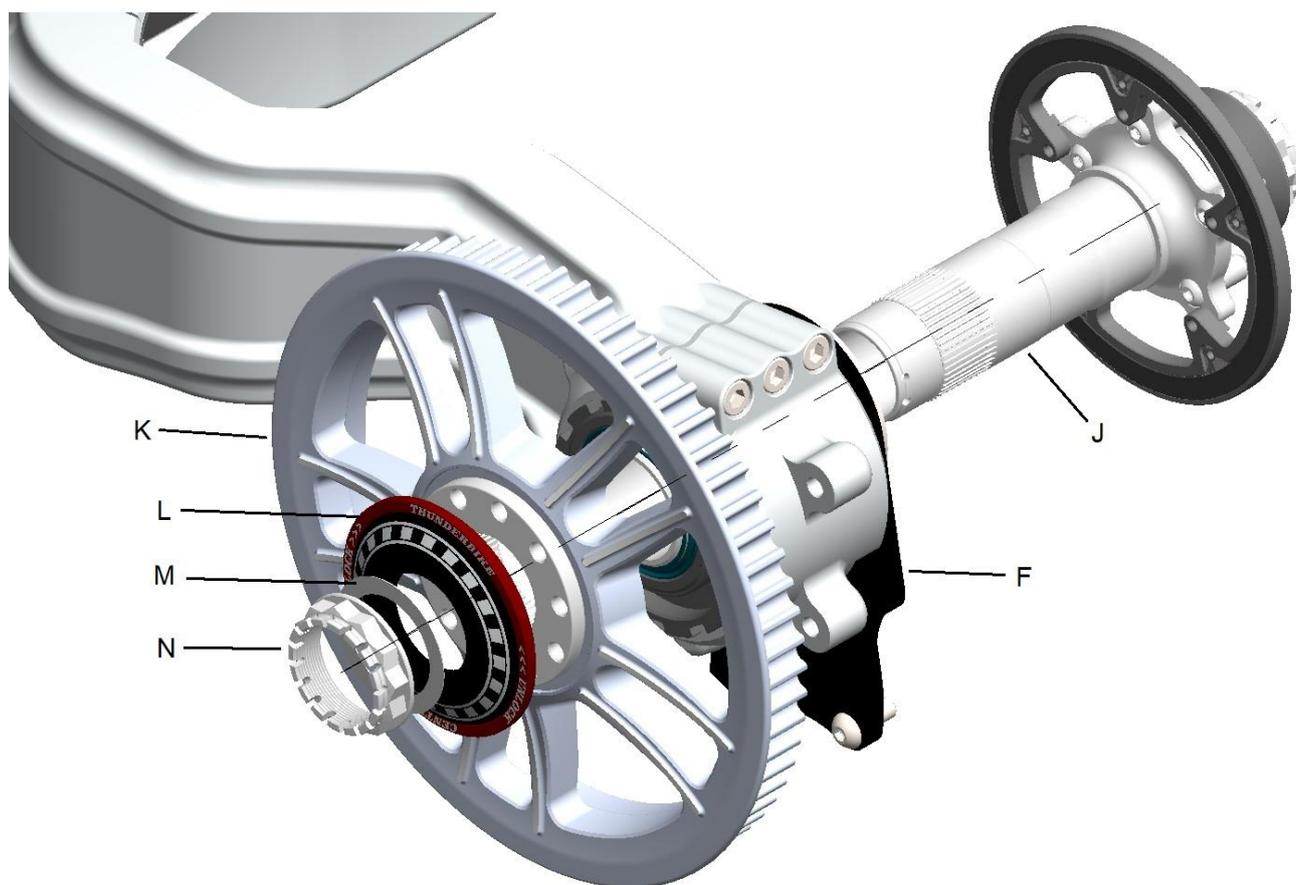
Dazu schieben Sie die Hinterachse (J) von der rechten Seite bis zum Anschlag in den Exzenter. Montieren Sie nun den hinteren Pulley (K), die Pulleyabdeckung (L), die Gleitscheibe (M) und anschließend die Achsmutter (N).
