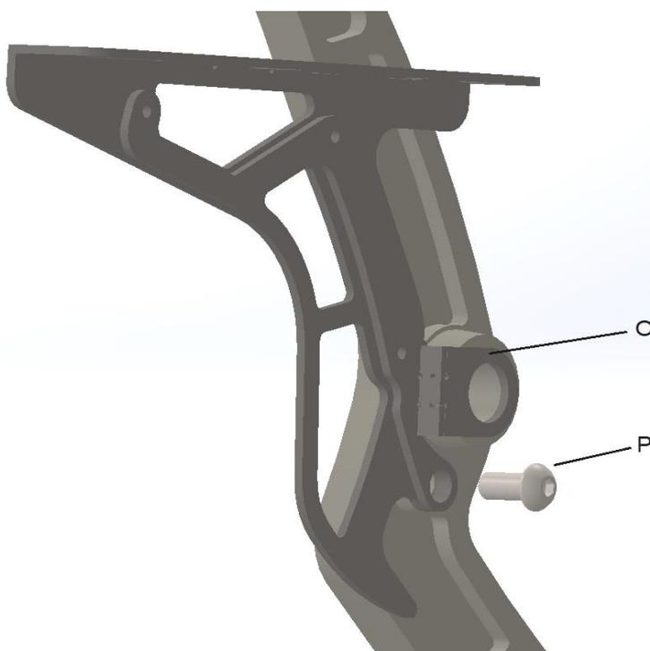
Montieren Sie die Hinterachse und den hinteren Pulley.
