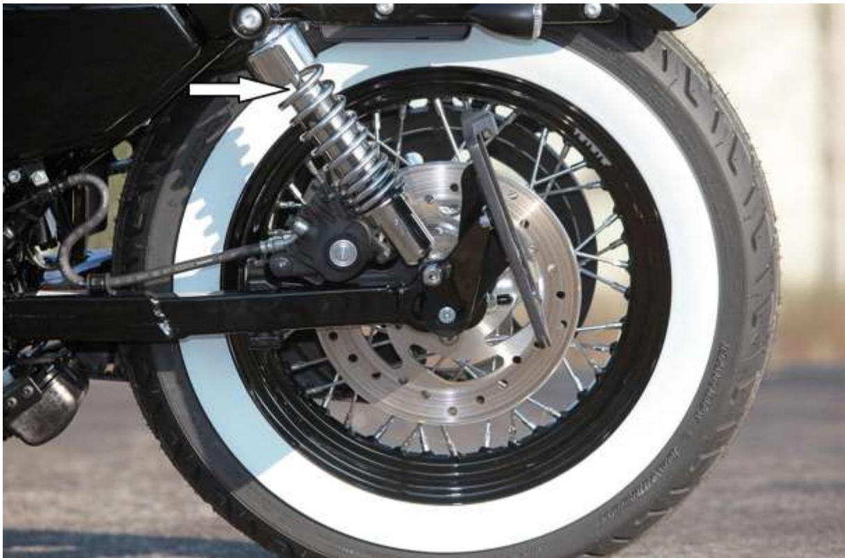
Überprüfen Sie die Schraubverbindungen nach einer Probefahrt.
