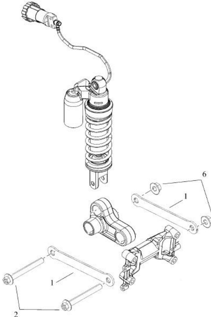
Montieren Sie die beiliegenden TB-Umlenkhebel an der Originalposition mit den Originalschrauben und ziehen Sie die Muttern gemäß den Herstellerangaben fest.
