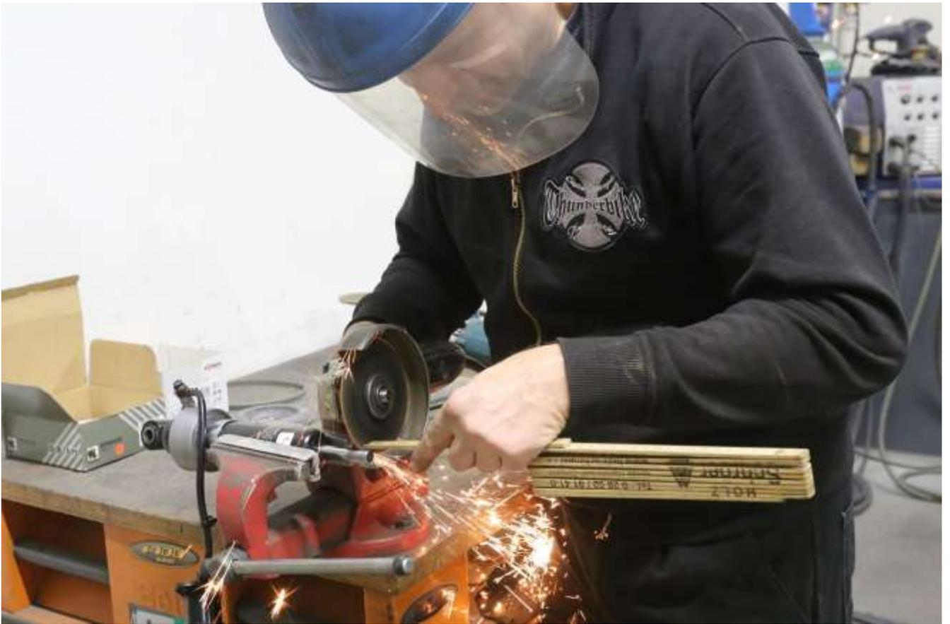
Bei der Tieferlegung um 30mm (Stage 2) muss das Gewinde der Kolbenstange um 10mm gekürzt werden.
