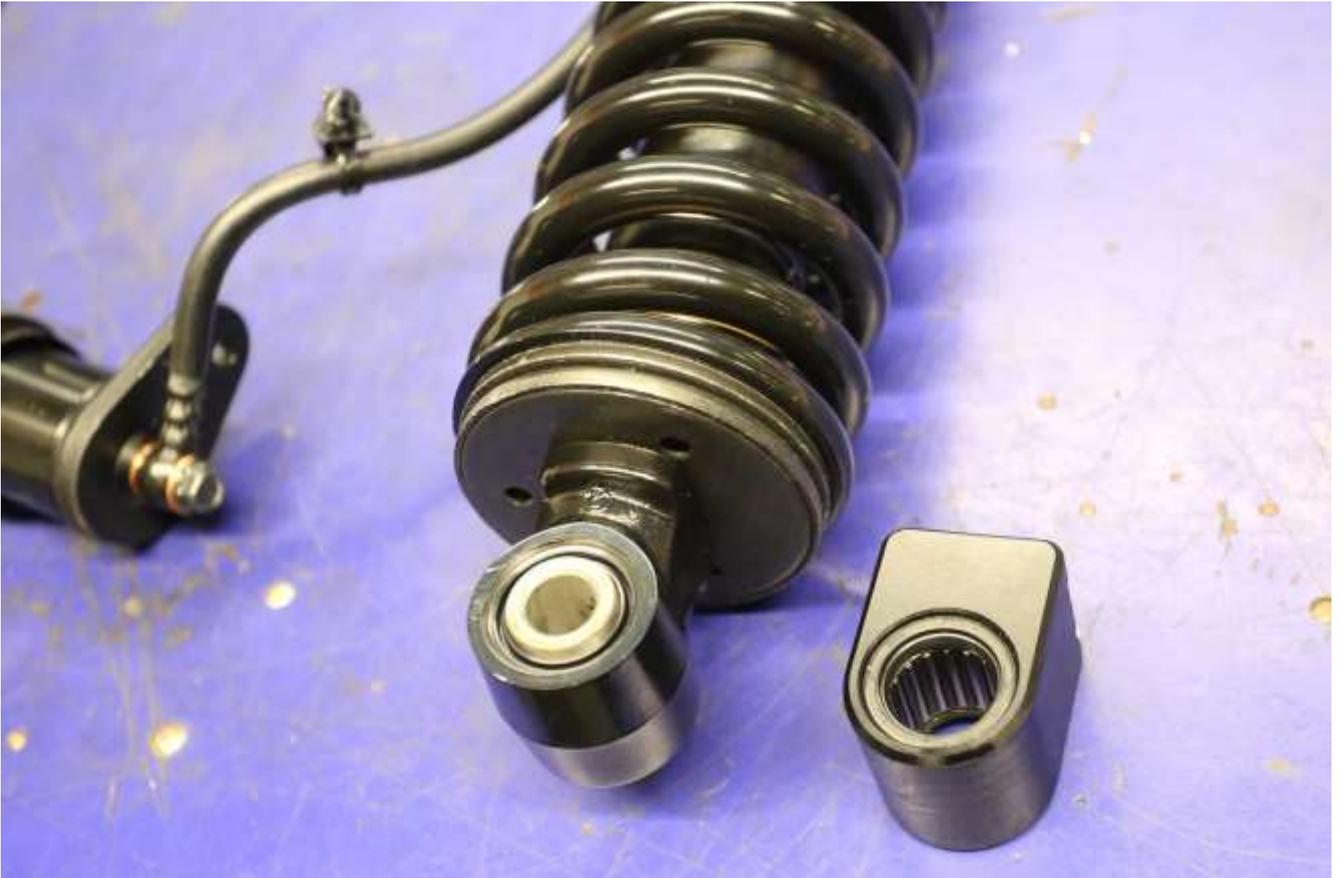
Spannen Sie den Stoßdämpfer in einen geeigneten Federspanner und spannen Sie die Feder bis zur Freigängigkeit des Dämpfers vor.
