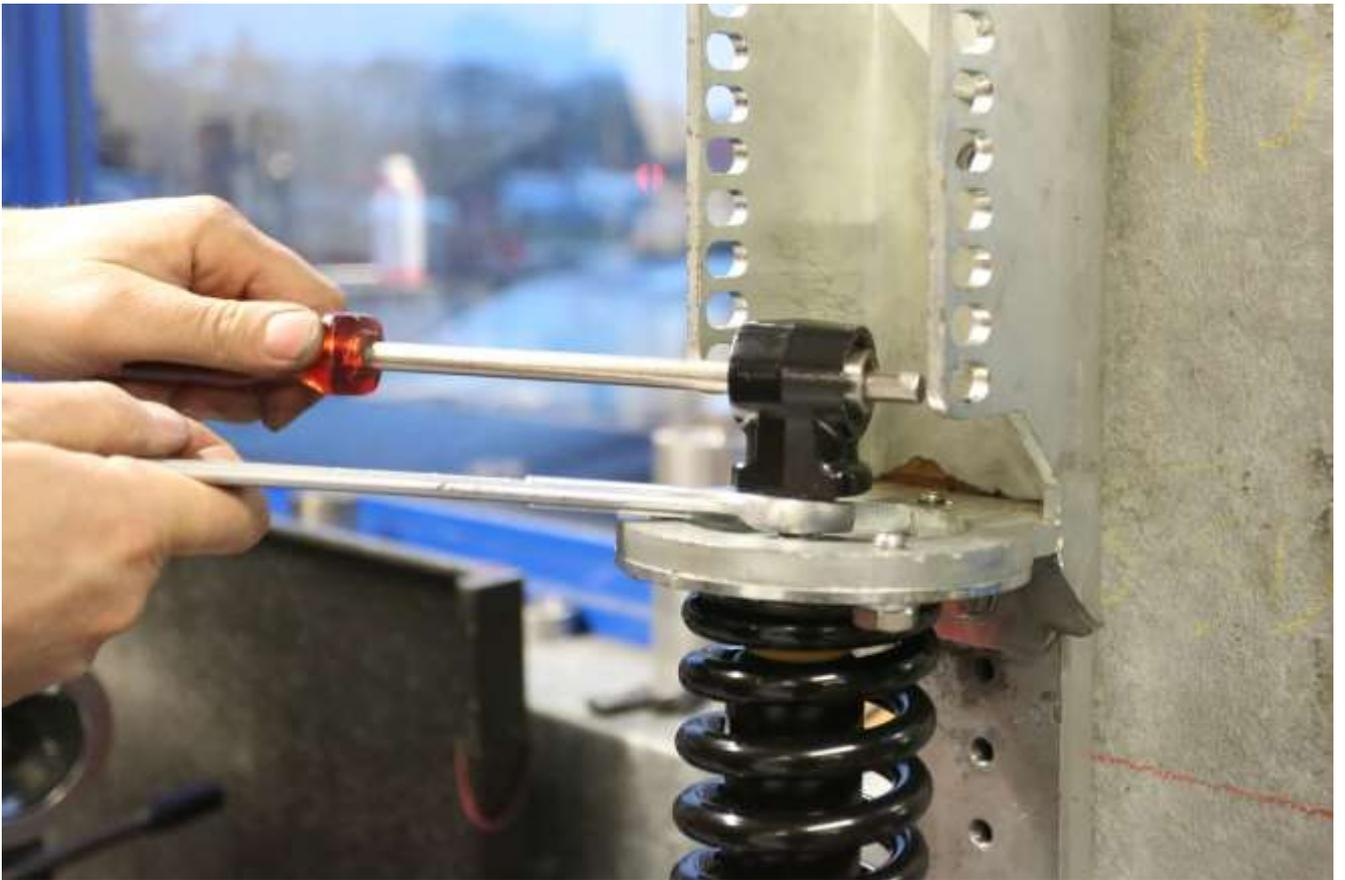
**Lösen Sie die Kontermutter und demontieren Sie den Originalkopf und die Kontermutter.**
