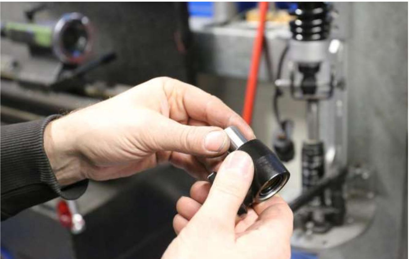
Bei Stage 1: Schrauben Sie den neuen Stoßdämpferkopf bis zum Anschlag auf die Kolbenstange und kontern Sie diesen anschließend.
