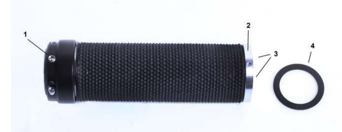
Entfernen Sie den Ring (2) an der Außenseite des Griffes und fixieren Sie den Griff mit den beiden innenliegenden Schrauben (3) an der Verzahnung. Stecken Sie den Ring (2) wieder auf und schrauben Sie ihn an.
