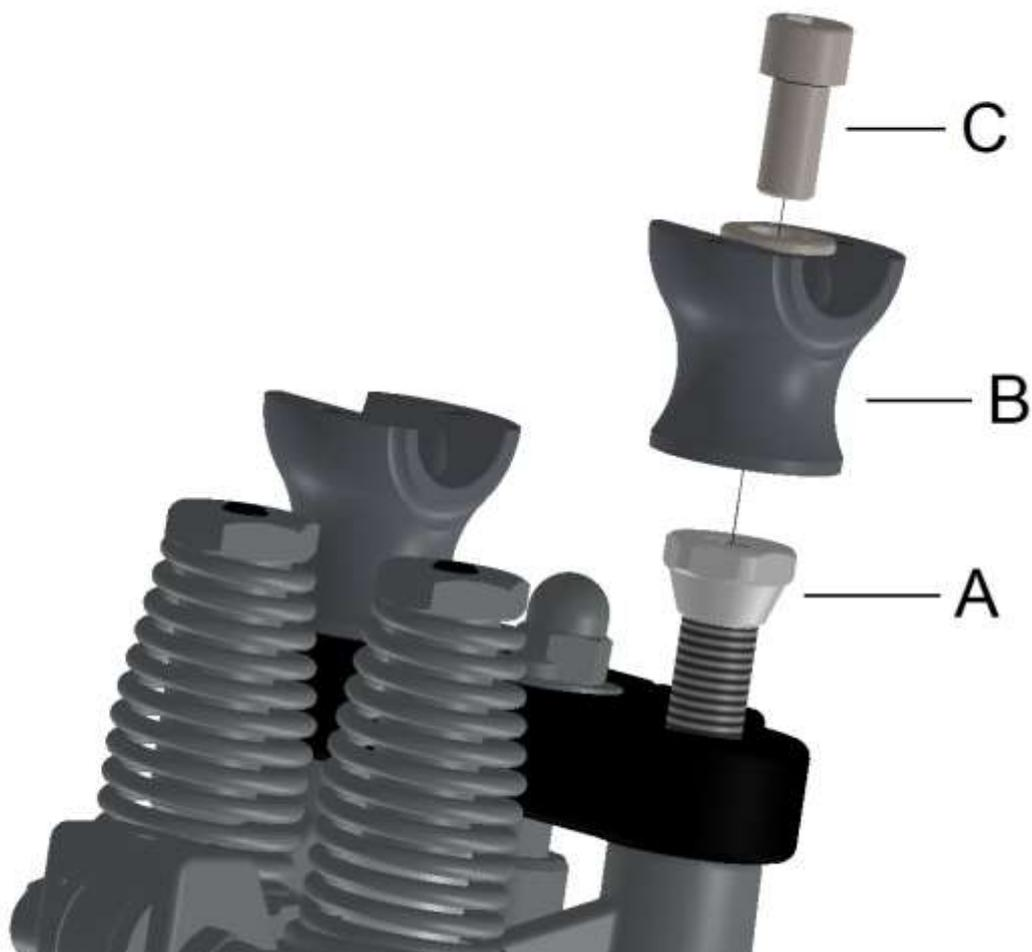
Schrauben Sie die beiliegenden Riser-Adapter (A) durch die obere Gabelbrücke in die Gabelholme und ziehen Sie die Adapter mit 81-88 Nm (60-65 ft-lbs) fest.
