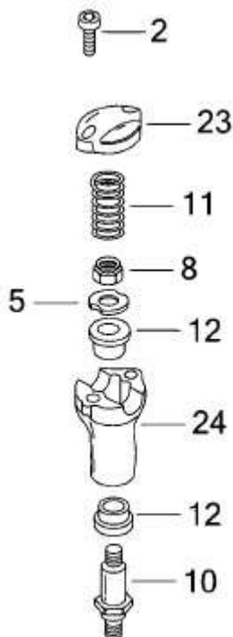
Lösen Sie die Klemmschrauben (2) und entfernen Sie das Riser-Oberteil (23).
