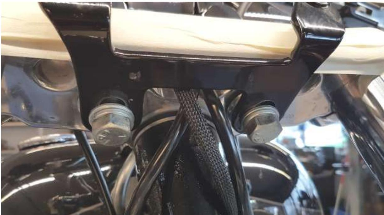
Schrauben Sie die Headlamp Cap mit den beiden Inbusschrauben von vorne an den Halter.
