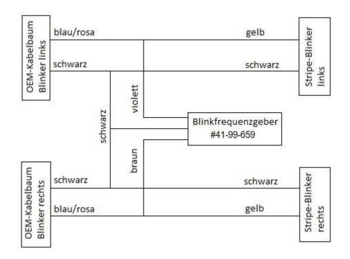
Isolieren Sie alle Kabelverbindungen sorgfältig! Wenn möglich diese Verbindungen mit Schrumpfschlauch isolieren. Achten Sie bei der Kabelverlegung darauf, dass Diese nirgends scheuern oder durch bewegliche Teile beschädigt werden können.
