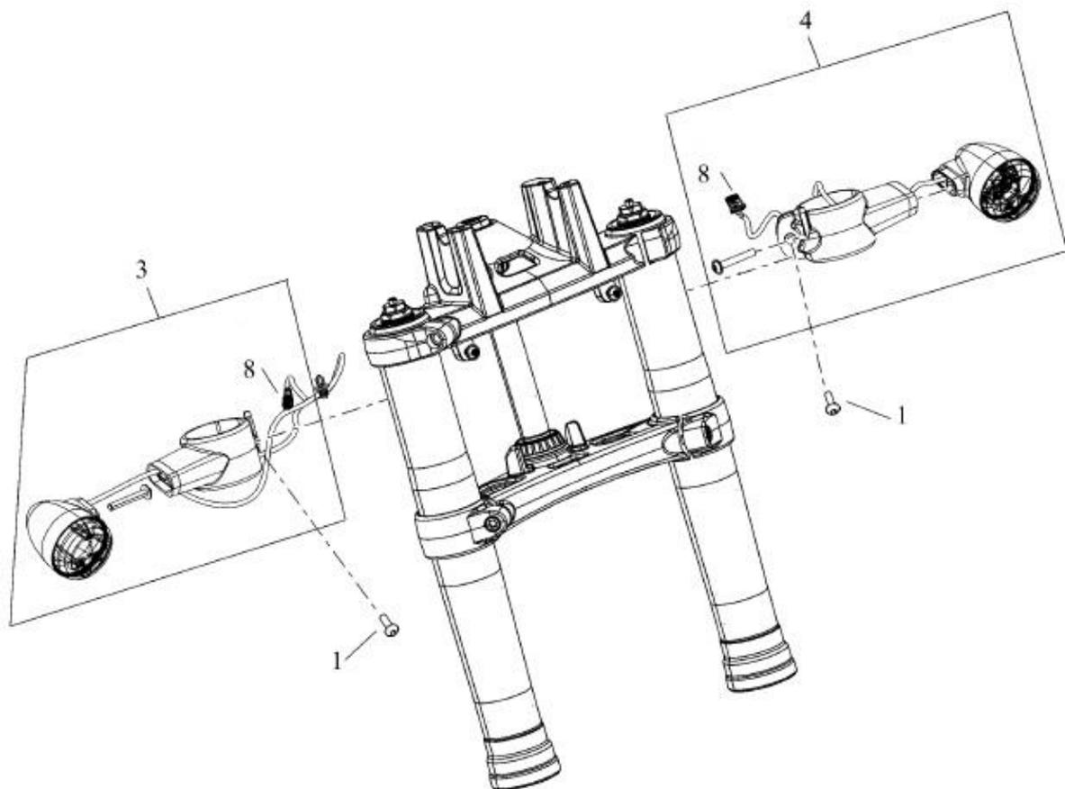
Montieren Sie die neuen TB-Blinker an den Gabelstandrohren.
