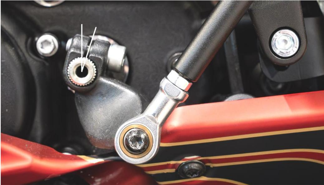
Befestigen Sie die Schaltstange mit der Originalschraube an der Aufnahme.
