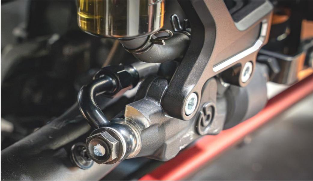
Anschließend kann die Bremsleitung im Bugspoiler verlegt werden.
