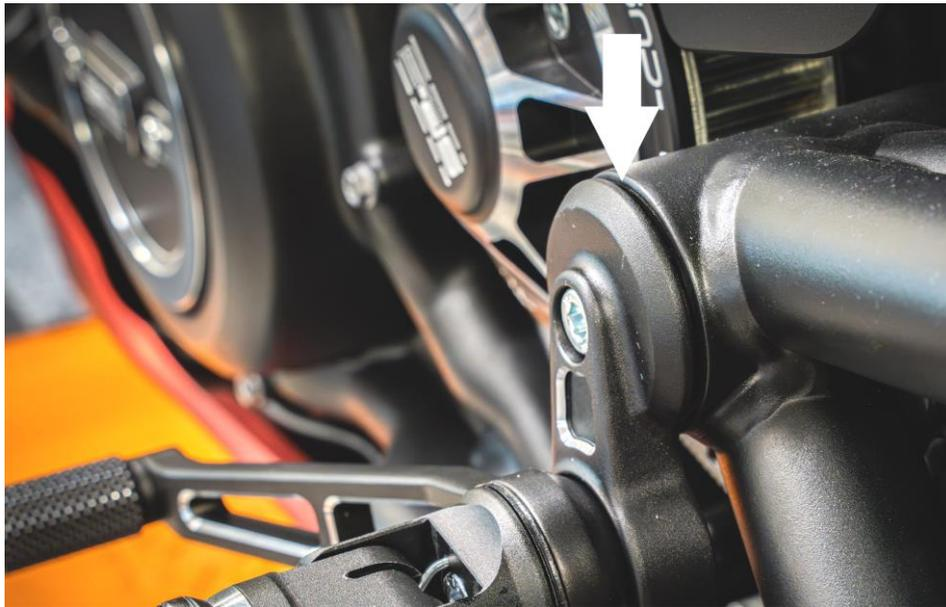
Montieren Sie die beiliegende Schaltstange mit der Linsenflanschschraube M6\*25, sowie der Scheibe 6\*15 und der Hutmutter, am Schalthebel.
