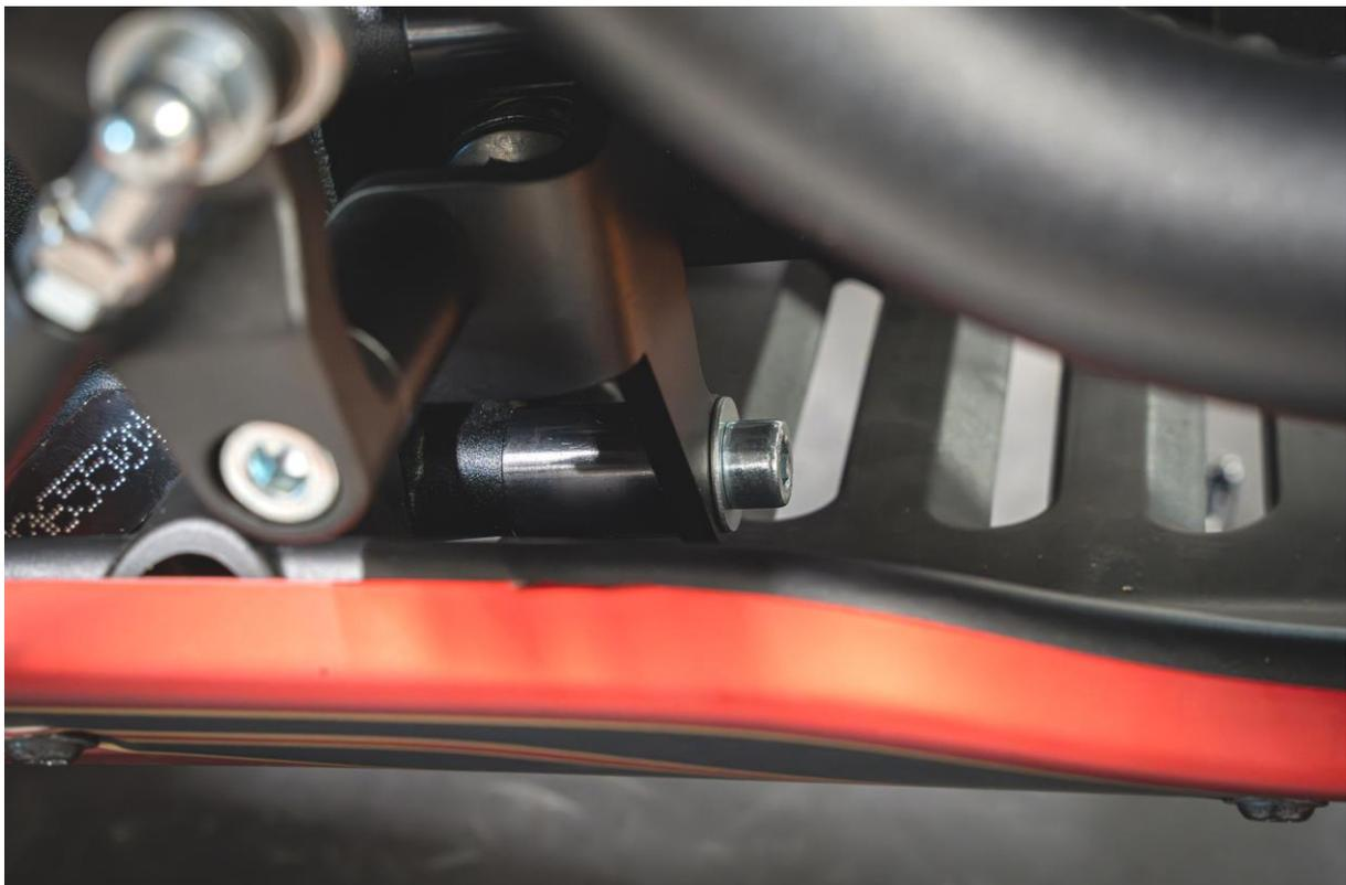
Montieren Sie den linken TB-Fußrastenträger mit der Inbusschraube M8\*55, sowie der Inbusschraube M8\*30 und ziehen Sie diese mit 25 Nm fest. Platzieren Sie dabei die beiliegende Hülse  $\varnothing 20 \times \varnothing 8,5 \times 32$  mm hinter der unteren Position.
