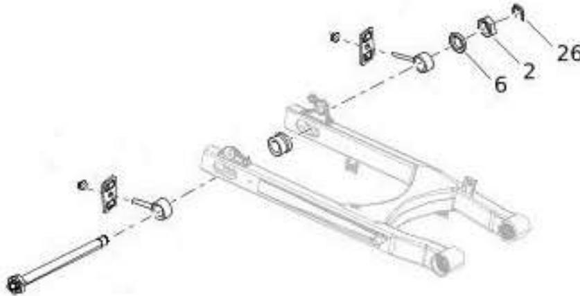
Montieren Sie anstelle der Unterlegscheibe den neuen TB-Kennzeichenhalter und ziehen Sie die Mutter der Hinterachse mit 140Nm fest.
