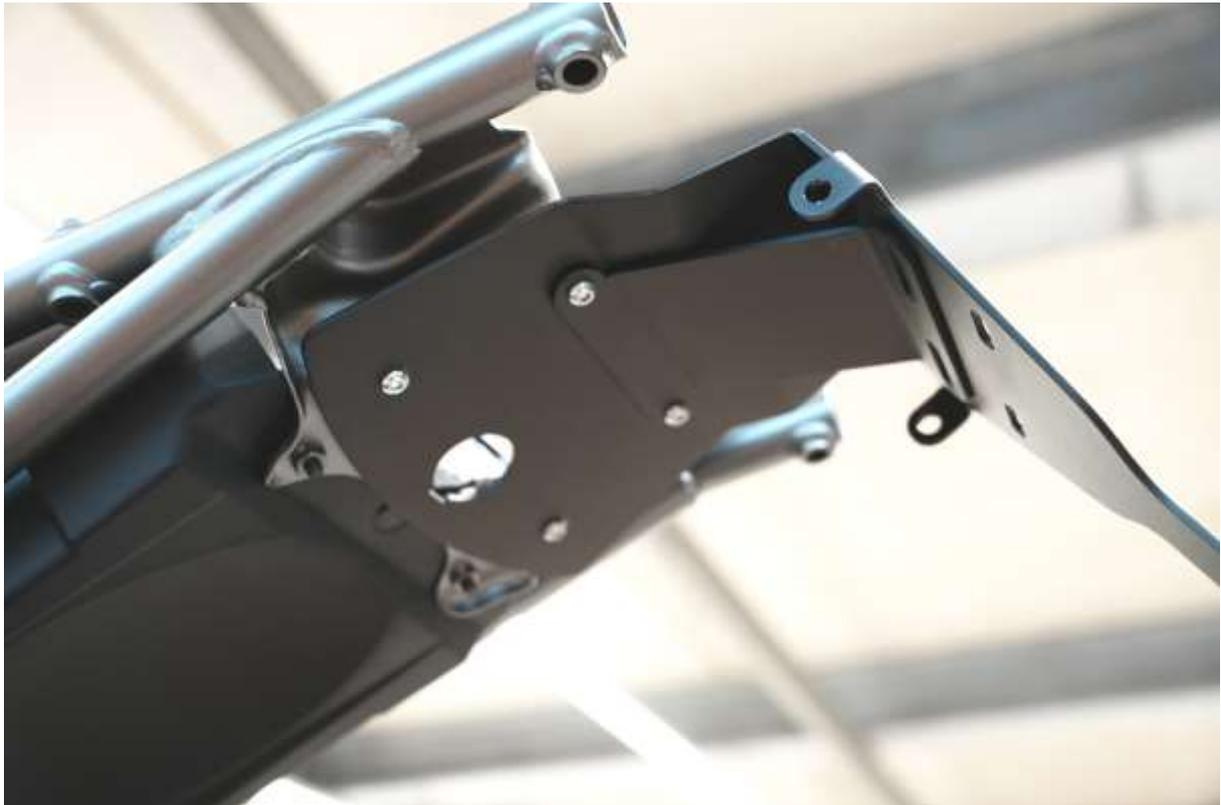
Installieren Sie die Kennzeichenbeleuchtung mit den beiliegenden Linsenschrauben M3\*8 und schließen Sie diese an das Bordnetz an.
