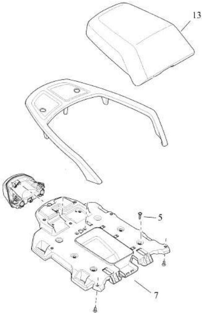
Lösen Sie die vier Befestigungsschrauben (5) und entfernen Sie die hintere Sitzgrundplatte (7) samt Rücklicht.
