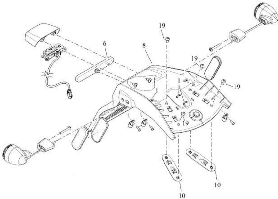
Lösen Sie die vier Befestigungsschrauben (19) und entfernen Sie die Halter (10).
