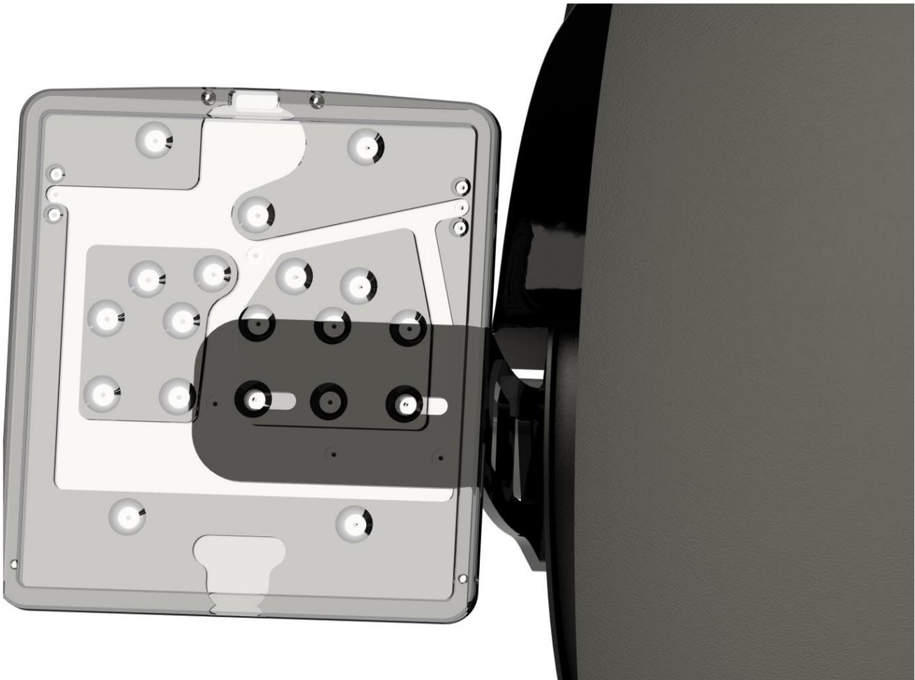
Montieren Sie die Kennzeichenbeleuchtung und schließen Sie diese an das Bordnetz an. Verlegen Sie das Kabel so, dass es nicht in Kontakt mit dem Hinterrad und dem Antriebsriemen kommen kann und fixieren Sie es mit den Kabelbindern!
