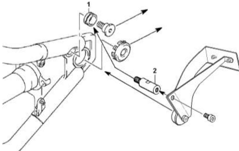
Stecken Sie die Haltebuchse des Kennzeichenträgers in die Öffnung vor der Hinterradachse und schrauben Sie den Halter an dem Bolzen an.
