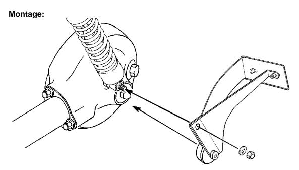
Entfernen Sie die Mutter und Scheibe der unteren Stoßdämpferaufnahme. Der Stoßdämpfer muss nicht demontiert werden.
