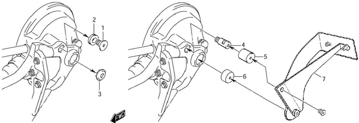
Stecken Sie die Haltebuchse (6) des Kennzeichenträgers in die Öffnung vor der Hinterradachse und schrauben Sie den Halter (7) an dem Bolzen an.
