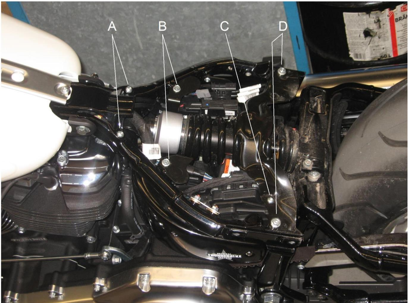
Entfernen Sie die Schrauben (A,B,C,D) und entfernen Sie die hintere Querstrebe über dem Stoßdämpfer.
