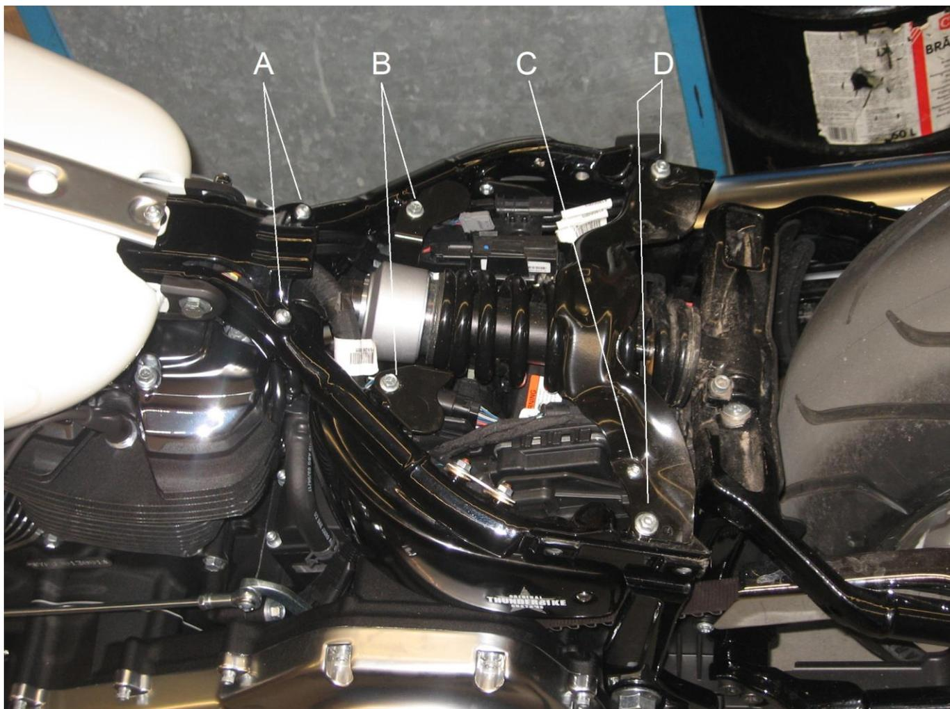
Entfernen Sie die Schrauben (A,B,C,D) und entfernen Sie den vorderen Sitzhalter, sowie die hintere Querstrebe über dem Stoßdämpfer.
